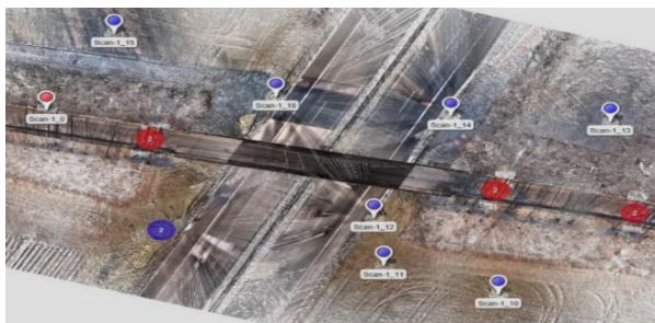
Lieferobjekte 3D-Bestandsaufnahme, stationäre Scans: Lageplan Scanstandorte Projekt: KaBa
